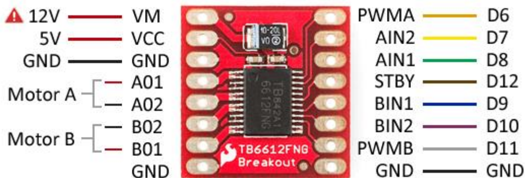
Рисунок 8. Драйвер моторов на основе TB6612.
